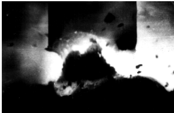
Рис. 1 – Характер переноса электродного металла при наплавке порошковой лентой
