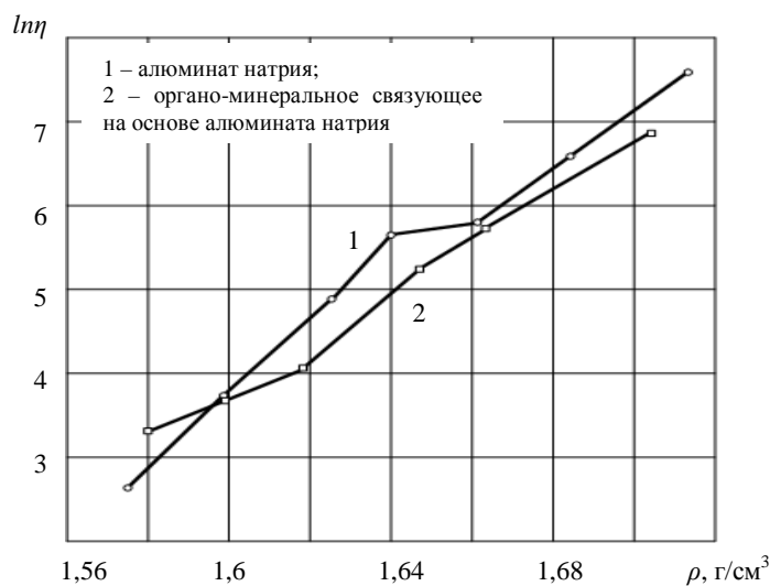
Рис. 1. Зависимость вязкости ( \eta ) связующего от его плотности ( \rho )
