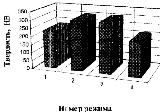
Рис. 4 - Влияние температуры закалки и условий охлаждения на твердость борсодержащей стали
